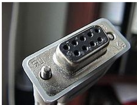
DB9 connector (RS-232) // Wtyk DB-9 (RS-232)
