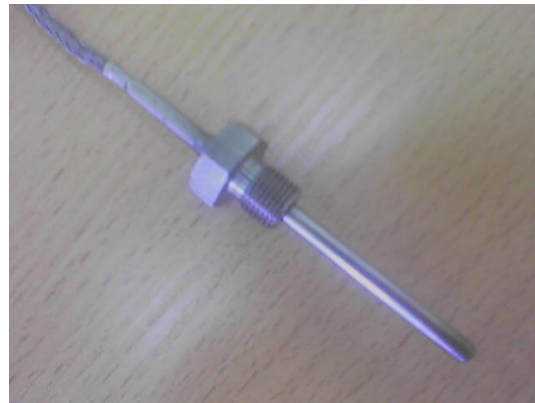
Fig. 1. Examples of design solutions PT100 thermometers //Rys. 1. Przykłady rozwiązań konstrukcyjnych termometrów PT100
