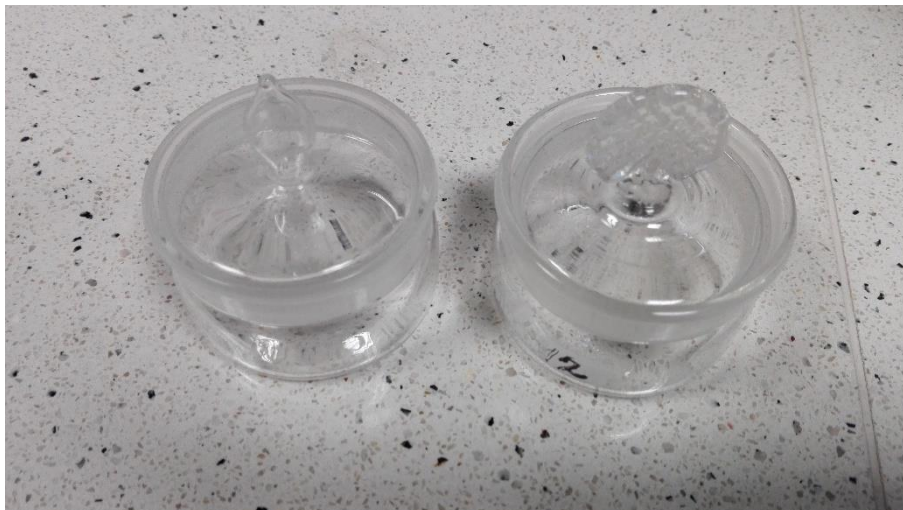
Rys. 2 Naczynka szklane z pokrywkami do wyznaczania zawartości wilgoci
