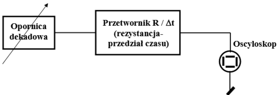
Rys. 2. Układ pomiarowy przetwornika rezystancja - przedział czasu
